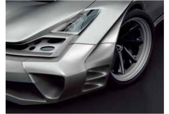
轻量且耐冲击性能卓越的PP复合材料应用于车保险杠
